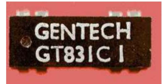
Relé reed con encapsulado de plástico y de forma muy similar a circuitos integrados.
